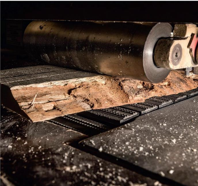
Die sorgfältig ausgewählten italienischen Ahornbäume werden im Spätherbst geschlagen und nach zwei Jahren Trocknungszeit in mehreren Arbeitsschritten zu Leisten gesägt. Im Wasserdampföfen und mit Hilfe einer hydraulischen Biegeblanchette erhalten die so gewonnenen Holzrohlinge nach und nach ihre Rundhakengriffform.
